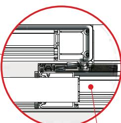
Guarnizione centrale a doppia pinna + palloncini e possibilità di installare diversi tipi di serrature.
